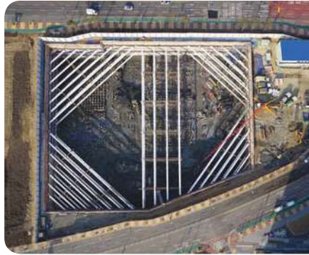
EBS 디지털 통합사옥 신축공사 · 굴착깊이 : 13~16m · PPS 설치 단수 & 길이 : 2 단 / 2,356m · PPS 직경 : ø 800mm
